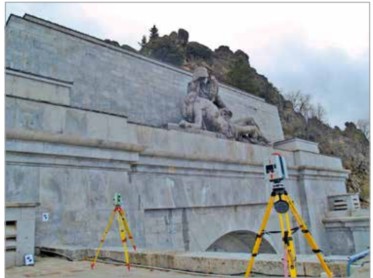
FIG. 74. Adquisición de dianas (Black&White) por ambos sistemas de registro: estación total y la combinación de TLS desde una de las exedras a mitad de altura.
