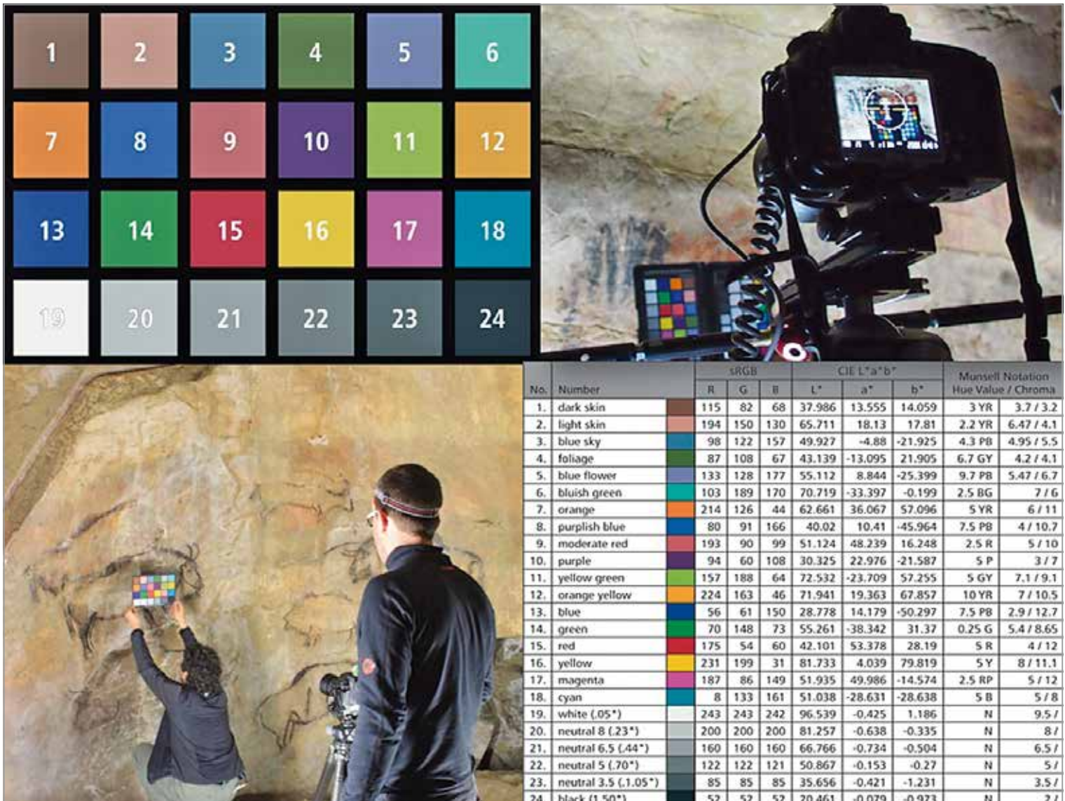
FIG. 85. Ejemplo de las técnicas utilizadas en la calibración del color mediante diferentes tipos de patrones de cartas de color estandarizadas con la asignación de los diferentes valores usados. Ejemplos del Salon Noir en la cueva de Niaux (abajo izquierda) y en la cueva de Roucadour (arriba derecha) (Angás et al., 2014: 28, FIG. 3).
