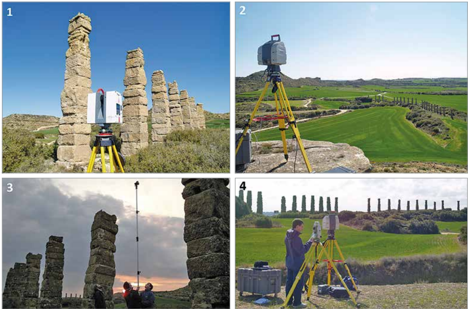
FIG. 131. Ejemplo de las diferentes técnicas (topografía, escáner 3D y fotogrametría) empleadas en la documentación gráfica y geométrica de cada estructura hidráulica.
