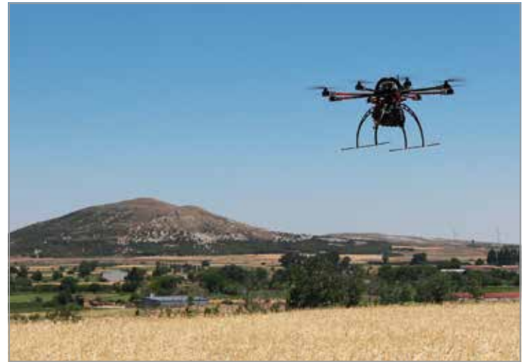
FIG. 37. Desarrollo de un dron multirrotor con integración de un sensor multispectral Tetracam Mini MCA 6 en el yacimiento arqueológico del Alto de la Cruz (Fréscano, Zaragoza).
