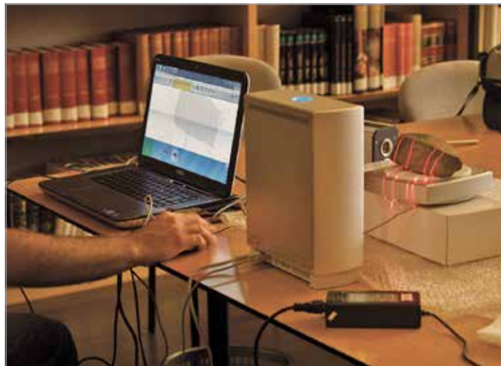
FIG. 49. Escáner de triangulación Next Engine documentando el bloque de Abautz en el Museo de Arqueología de Navarra.
