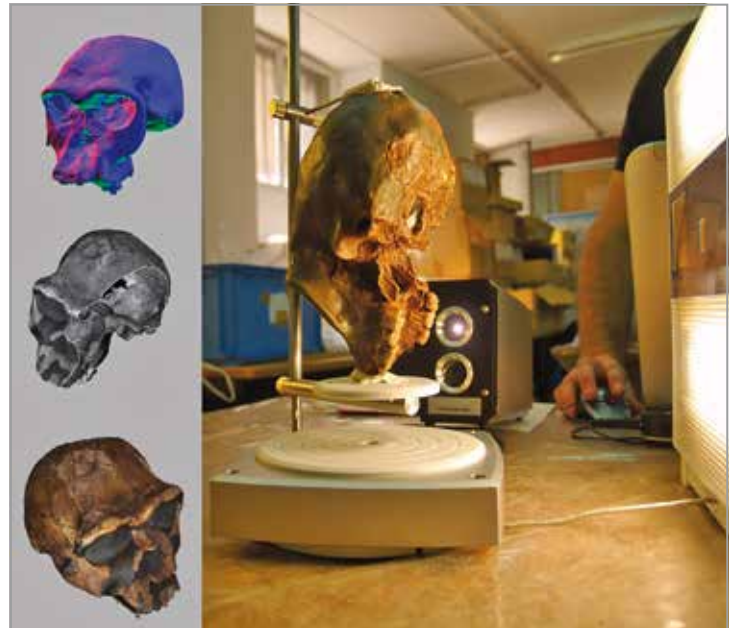
FIG. 67. Proceso de registro y texturización (izquierda) del modelo 3D de una réplica de cráneo de Australopithecus afarensis . Detalle de la digitalización realizada mediante una técnica combinada de escáneres 3D de objeto cercano de triangulación (modelo NextEngine a la derecha) y luz blanca estructurada (modelo Artec S al fondo) de un modo sincronizado con una peana circular motorizada.
