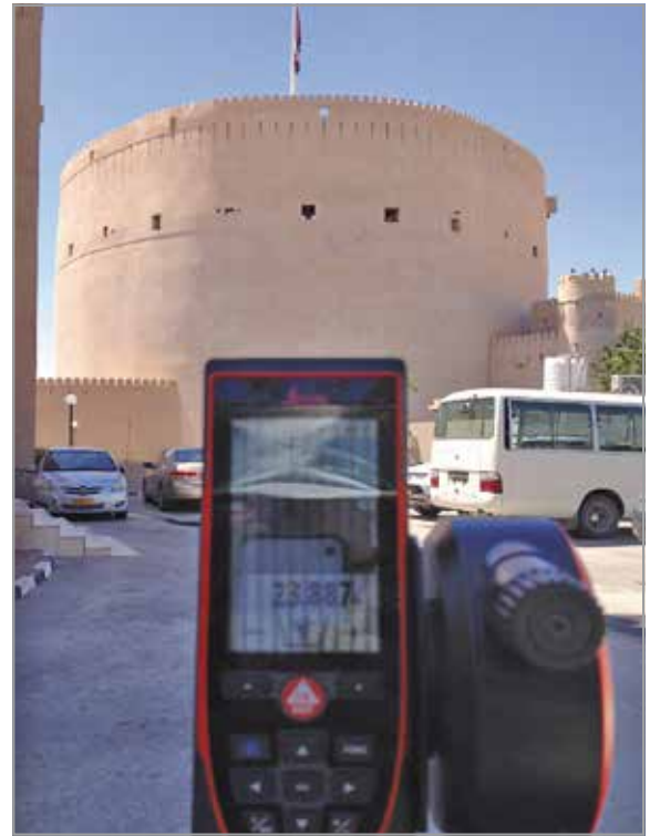
FIG. 61. Ejemplo de documentación con técnicas de bajo coste. Utilización de un distanciómetro láser con sensor de inclinación sobre trípode para modelado tridimensional arquitectónico de la torre de Nizwa (izda.) y el fuerte de Khandaq en Buraimi (dcha.) en el Sultanato de Omán.
