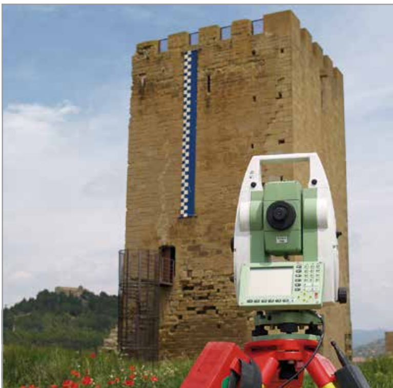
FIG. 47. Ejemplo de estación total robotizada en el levantamiento topográfico del Castillo de Uncastillo (Torre del Homenaje y Palacio) en la Peña de Ayllón (Uncastillo, Zaragoza) para la Fundación Uncastillo.
