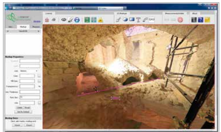
FIG. 120. Servidor web de los ficheros 3D de cada uno de los escaneados. Advértase la medición sobre la nube de puntos en una de las zonas que se conservan los basamentos de los arcos radiales.
