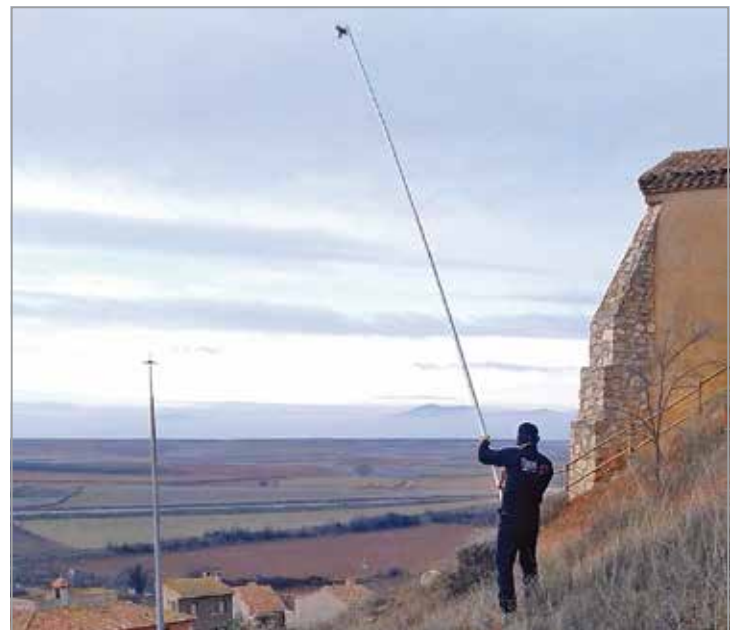
FIG. 62. Sistema de pértiga portátil extensible de 5 metros para su uso mediante técnicas fotogramétricas en áreas arqueológicas. Yacimiento arqueológico «El Castillo» Villarroya del Campo (Zaragoza). Fot. Francisco Javier Gutiérrez.
