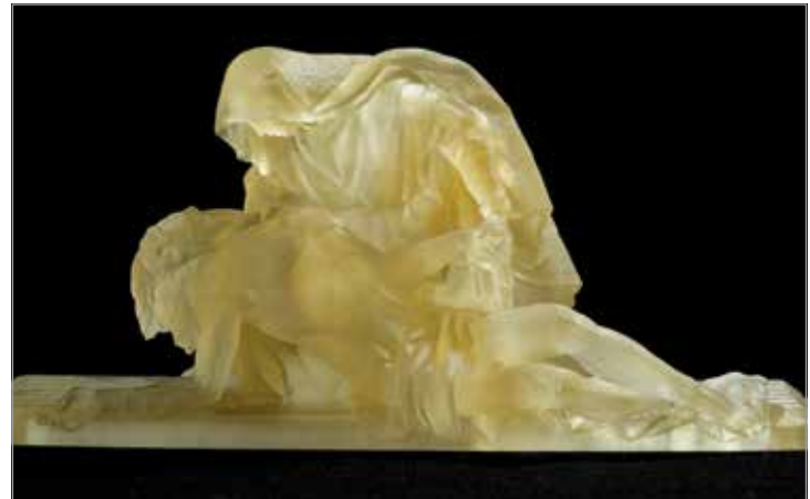
FIG. 78. Reproducción con técnicas aditivas de impresión 3D de la escultura a escala 1:50 en resina RGD720 realizada por el Departamento de Ingeniería de Diseño y Fabricación de la Universidad de Zaragoza*.
