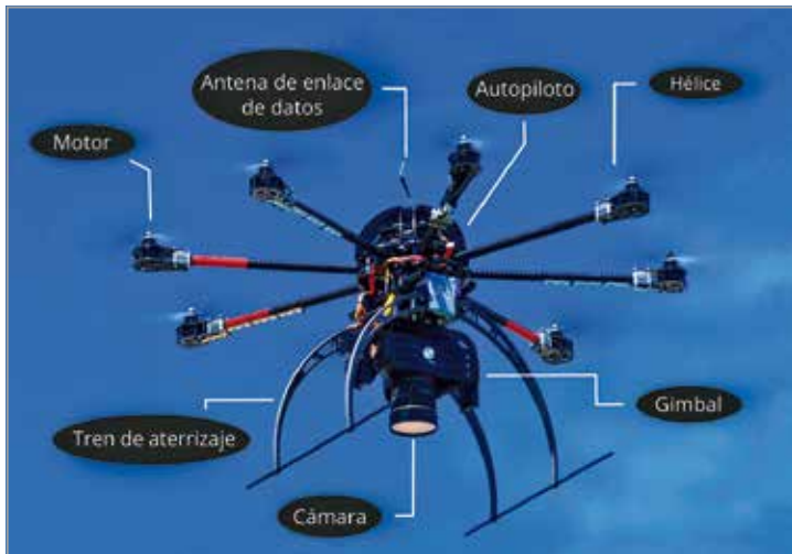
FIG. 36. Descripción de las principales partes de uno de los drones desarrollados del tipo multirrotor.
