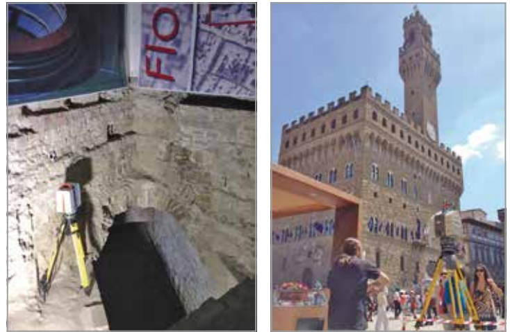
FIG. 119. Toma de datos mediante un escáner de diferencia de fase en una de las zonas interiores y escáner de TOF en la zona exterior desde la Piazza della Signoria con el objetivo de contextualizar el espacio interior dentro del conjunto histórico urbano.
