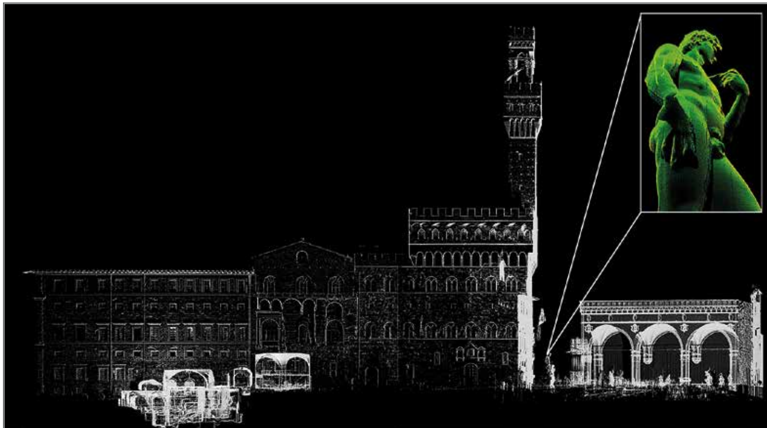
FIG. 69. Detalle de la réplica del David de Miguel Ángel en la Piazza della Signoria (Florencia) sobre la nube de puntos del alzado compuesto del Palazzo Vecchio y la terza corte. Registro realizado con un escáner de tiempo de vuelo Leica ScanStation.
