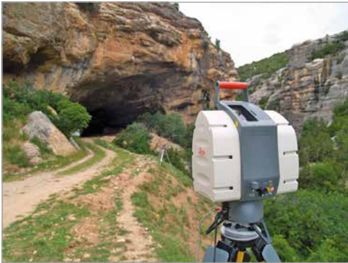
FIG. 171. Registro topográfico del entorno y acceso de la cueva de Chaves con un láser escáner 3D de tiempo de vuelo.
