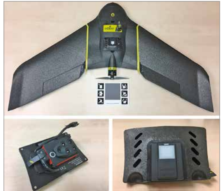
FIG. 45. Dron de ala fija eBee Plus RTK / PPK con un sensor multispectral Sequoia, sensor de luminosidad y tablilla de calibración.
