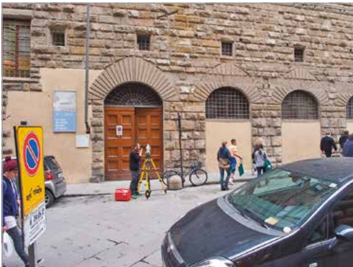
FIG. 118. Toma de puntos de control y dianas mediante estación total con distanciómetro láser.
