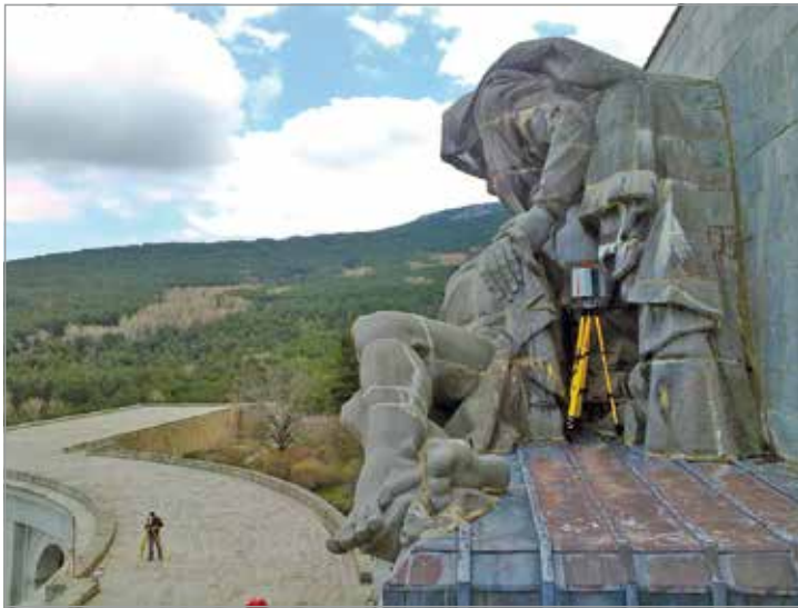
FIG. 73. Toma de datos con un escáner de diferencia de fase en la base de la escultura y con una estación total desde uno de los extremos de las exedras inferiores.
