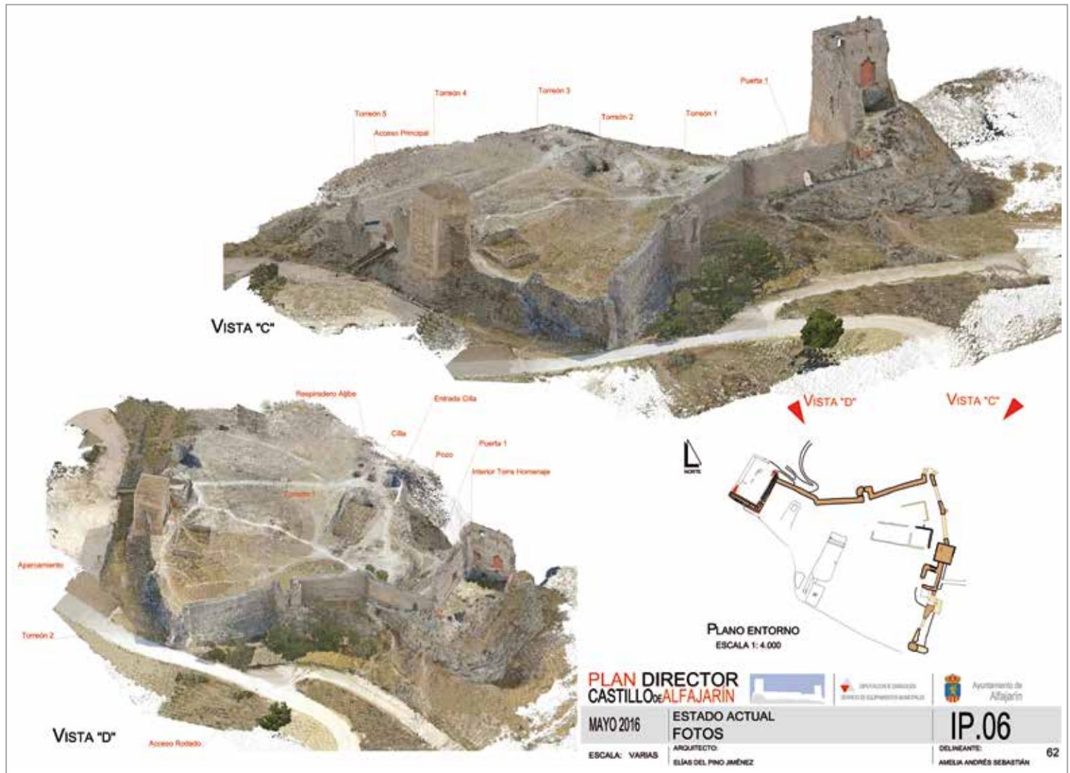
FIG. 221. Ejemplo de integración interdisciplinar de modelos tridimensionales en planes directores de monumentos arquitectónicos para establecer el estado actual y un plan de intervención. Plan Director del Castillo de Alfajarín (2016). Diputación Provincial de Zaragoza. Arqu. Elías del Pino. Dib. Amelia Andrés.
