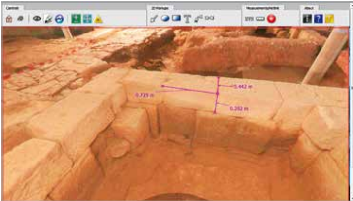
FIG. 103. Detalle de medición tridimensional sobre el modelo panorámico métrico en formato web de la zona del templo y tabla de errores.
