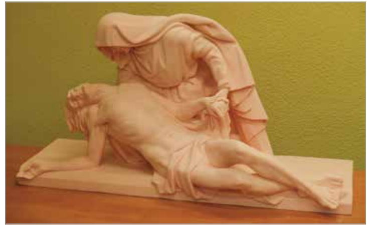
FIG. 77. Reproducción de la escultura a escala 1:10 en poliuretano D80 de alta densidad realizado mediante técnicas de sustracción.
