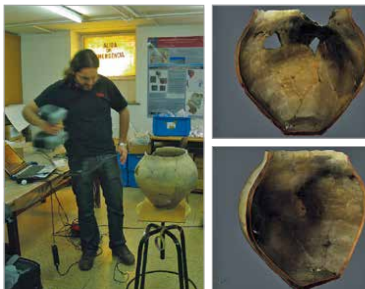
FIG. 66. Escaneado de un vaso de cerámica restaurado, mediante un escáner de luz blanca estructurada. La anchura de la boca permitió realizar el escaneado interior, obteniendo el modelo completo, apreciándose el grosor de las paredes. Imagen de la derecha: modelo en PDF3D y diferentes secciones de los ejes x, y, z.
