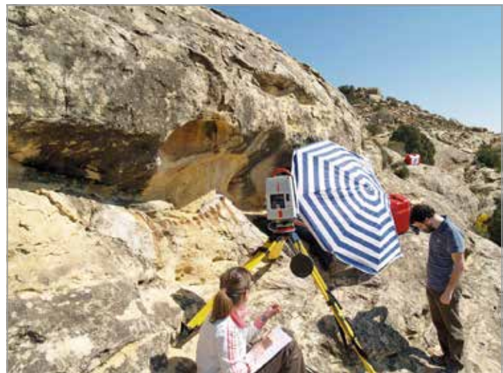
FIG. 210. Registro en campo del abrigo del Plano del Pulido en Caspe con la combinación de dos sistemas de digitalización tridimensional de triangulación y de diferencia de fase
