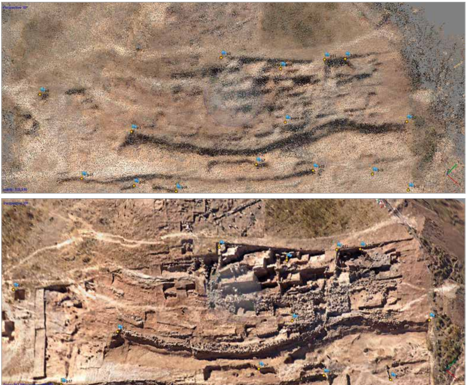
FIG. 192. Generación de nube puntos densa de todo el yacimiento (arriba) con los puntos de control colocados (GCP), y generación de modelo 3D en la parte baja.
