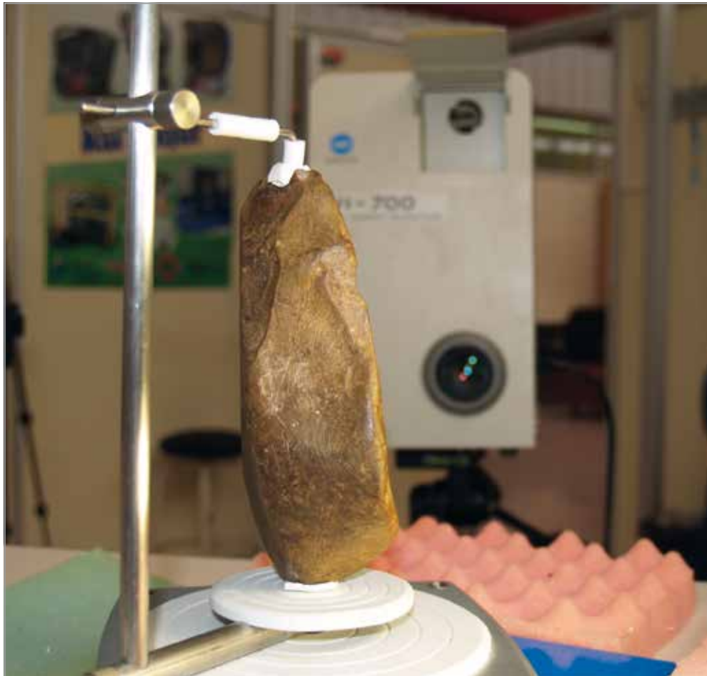
FIG. 1. Mapa grabado del bloque 1 de la cueva de Abauntz, en la Ulzama (Navarra) durante el proceso de documentación con un escáner de triangulación (a partir del original de Utrilla et al. , 2009: 102).
