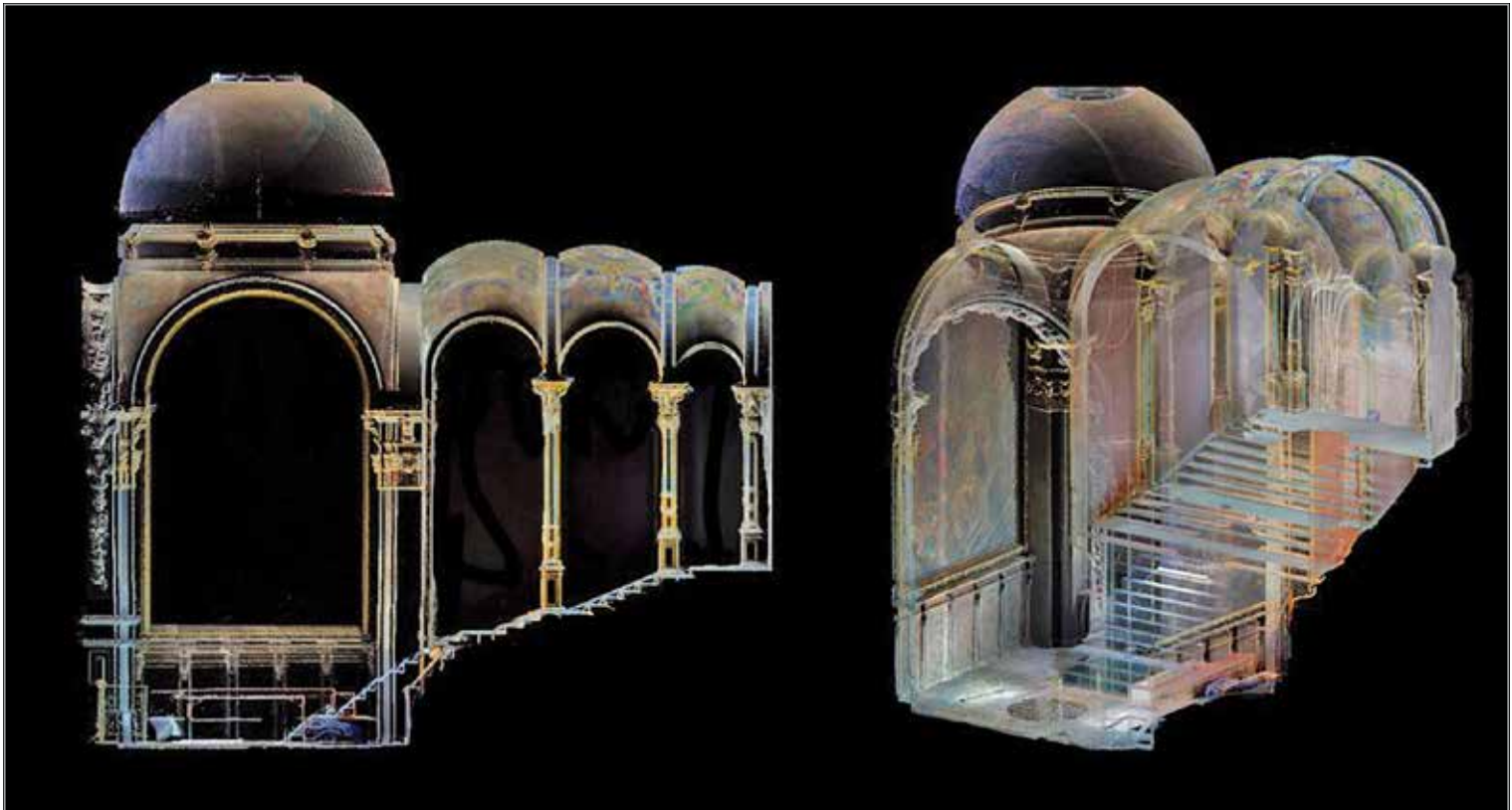
FIG. 222. Reproducción de una vista axonométrica y sección longitudinal sobre la nube de puntos de la Capilla de San Marcos (Seo de Zaragoza)*.
