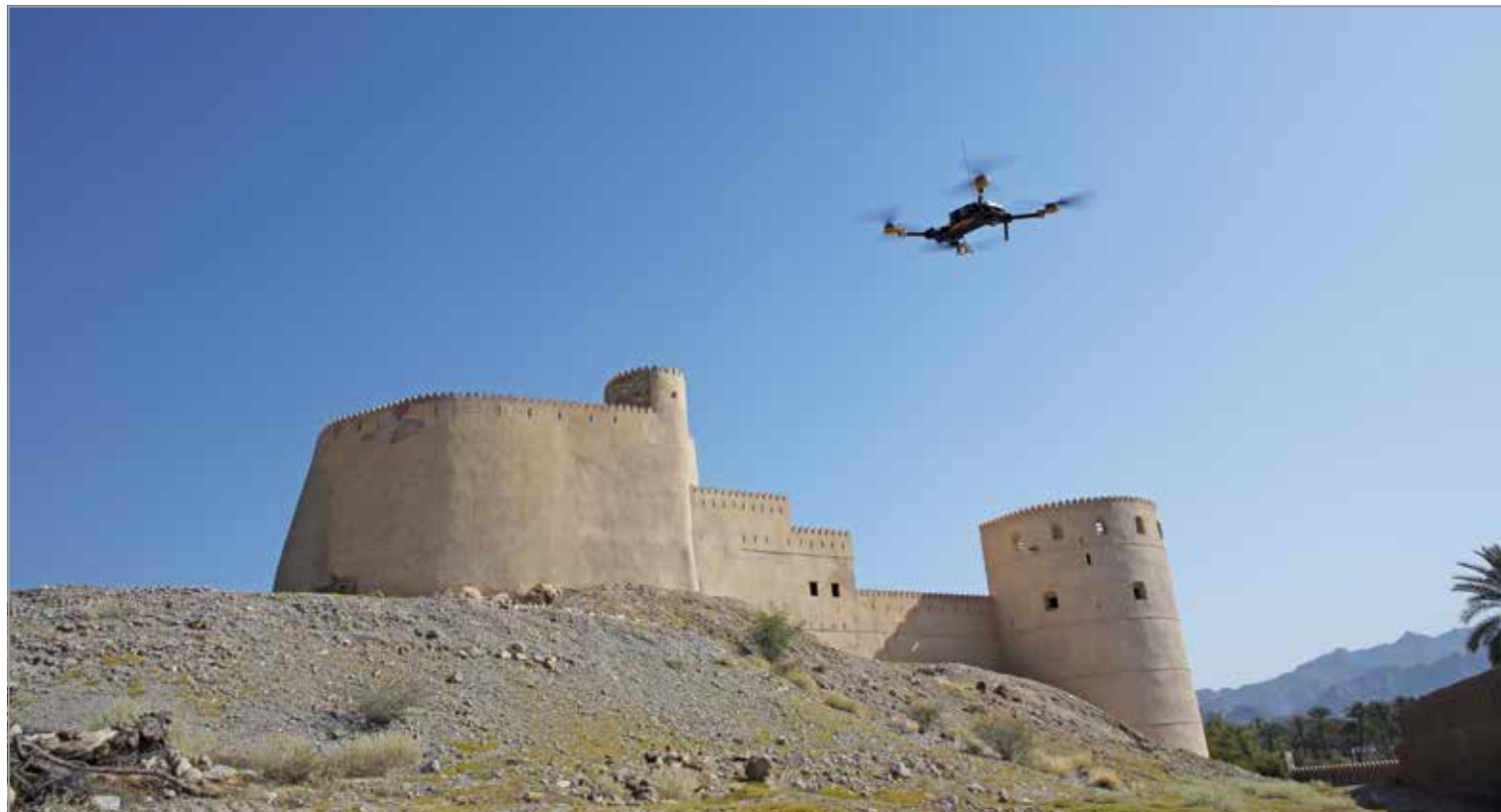
FIG. 40. Desarrollo de un dron tipo multirrotor «quad» sin gimbal en la toma de datos de la fortaleza de Rustaq (Sultanato de Omán).
