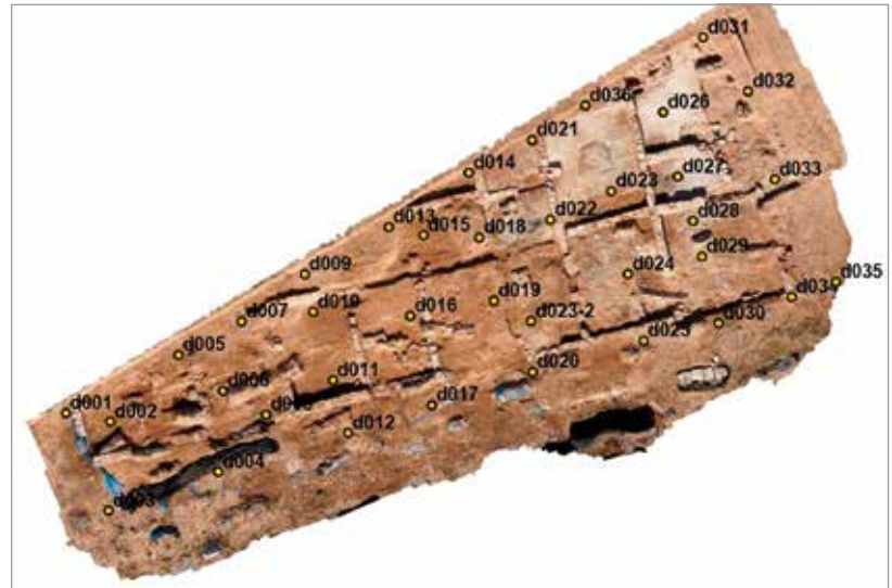
FIG. 92. Esquema de los puntos de control GCP sobre la ortofoto adquiridos mediante un sensor GNSS de doble frecuencia para la reconstrucción tridimensional mediante correlación automática de imágenes.
