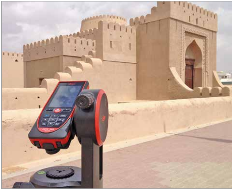
FIG. 61. Ejemplo de documentación con técnicas de bajo coste. Utilización de un distanciómetro láser con sensor de inclinación sobre trípode para modelado tridimensional arquitectónico de la torre de Nizwa (izda.) y el fuerte de Khandaq en Buraimi (dcha.) en el Sultanato de Omán.
