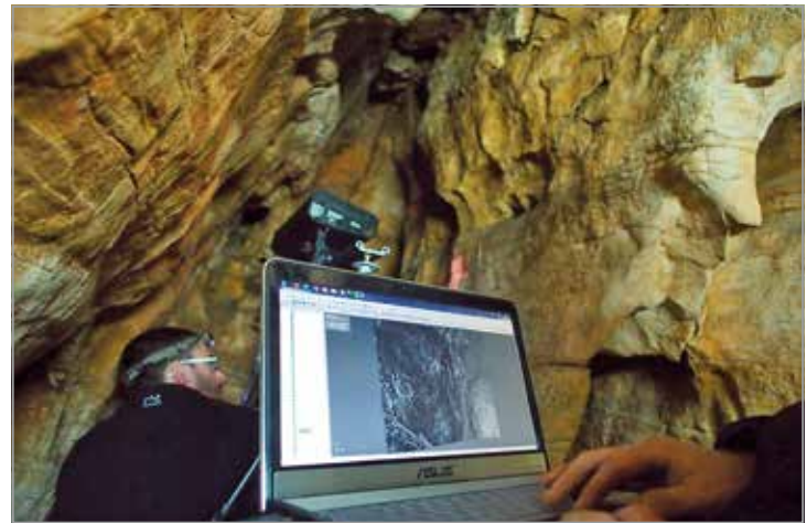
FIG. 220. Sistema slider diseñado para la documentación de pinturas y grabados rupestres en cuevas y abrigos para (1) una correlación automática de imágenes (arriba) y (2) escáner de luz blanca estructurada (abajo). Cueva de Roucadour, Thémimes (Angás / Le Guillou / Mauduit, 2014: 32).
