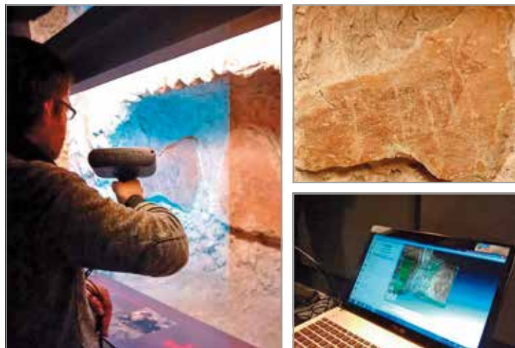
FIG. 174. Proceso de digitalización mediante un escáner 3D de luz blanca estructurada en el Museu d'Arqueologia de Catalunya .
