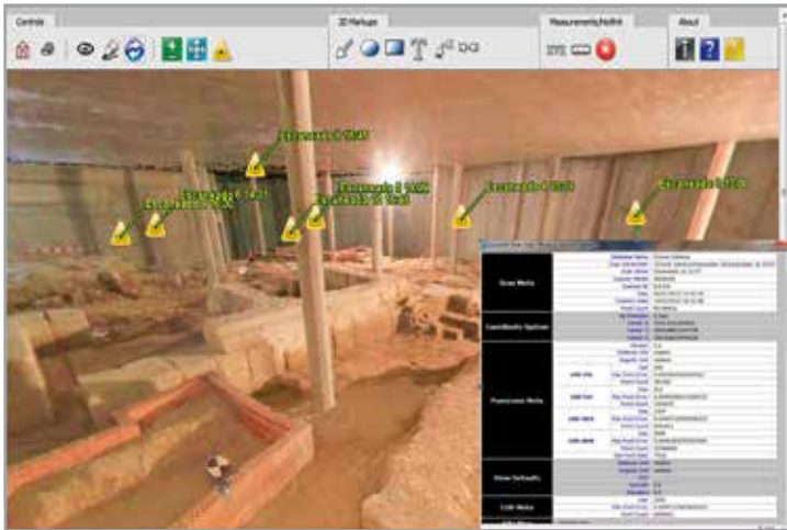
FIG. 102. Visor métrico esférico en formato html para su difusión mediante una plataforma web data server con la incorporación de los metadatos clave para su clasificación.
