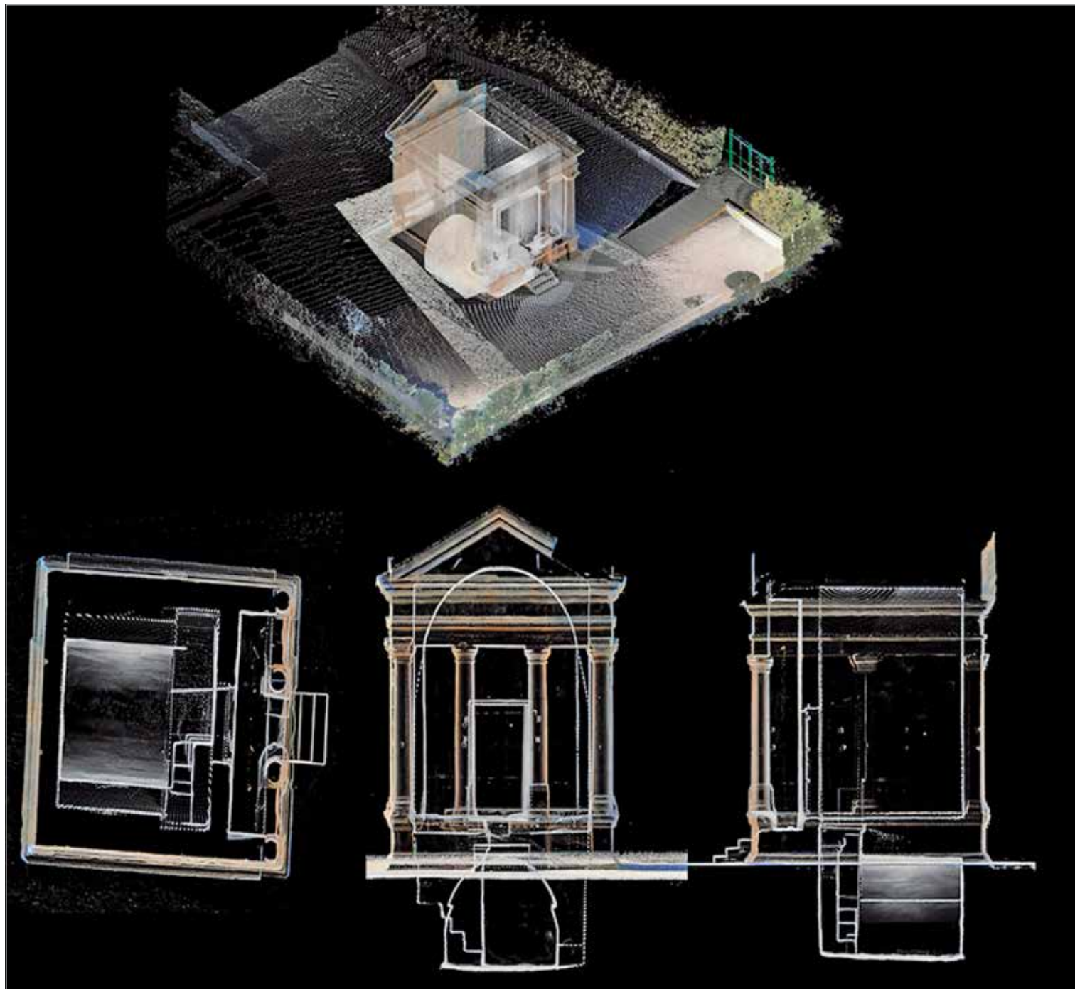
FIG. 197. En esta pág. y la siguiente: nube de puntos y árbol de capas sobre el modelo tridimensional en PDF3D del Mausoleo de Fabara con diferentes secciones longitudinales, transversales y horizontales*.
