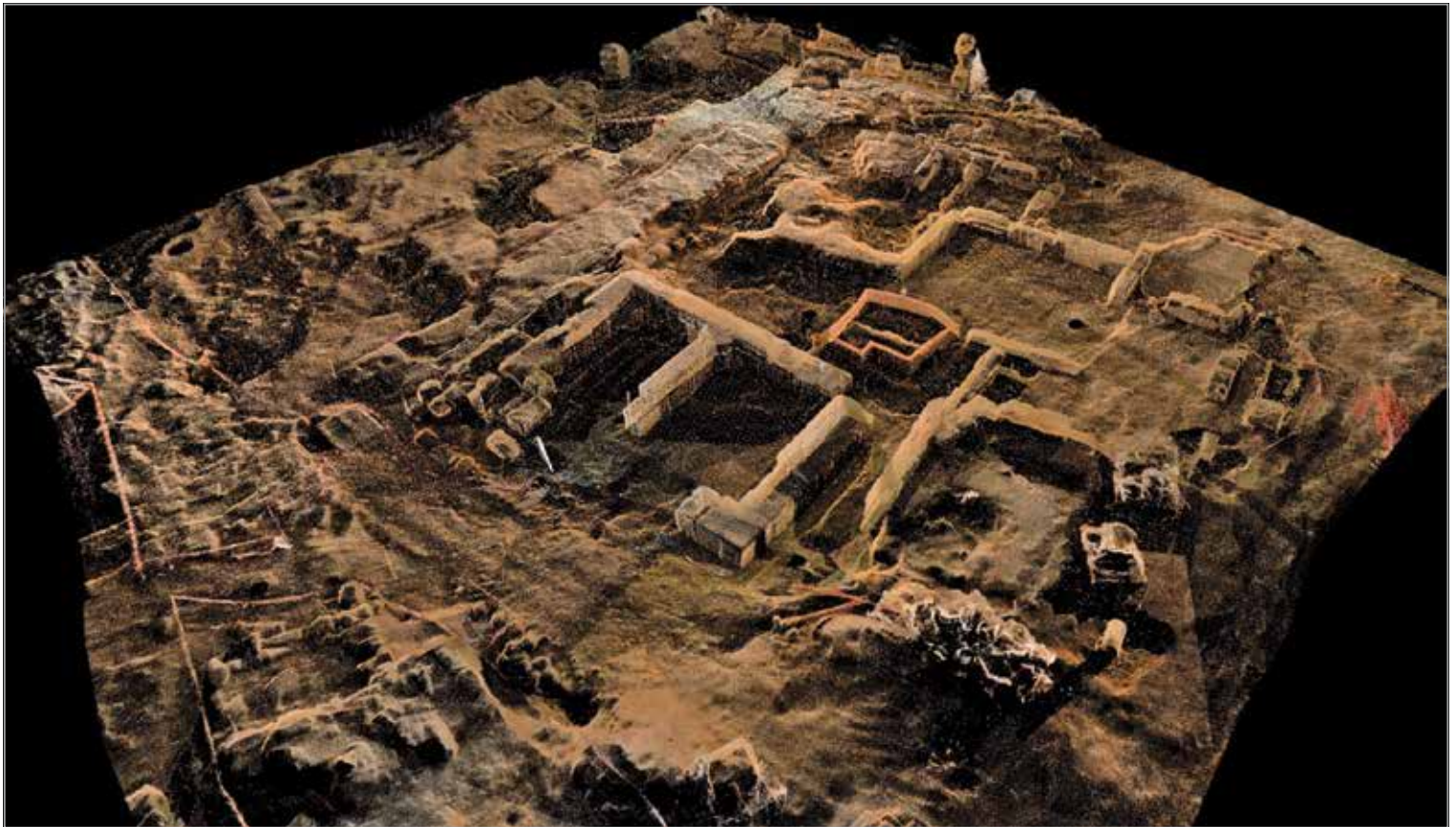
FIG. 100. Vista de la nube de puntos registrada de todo el conjunto arqueológico, prescindiendo de los elementos arquitectónicos modernos, con una resolución media de 3 mm.
