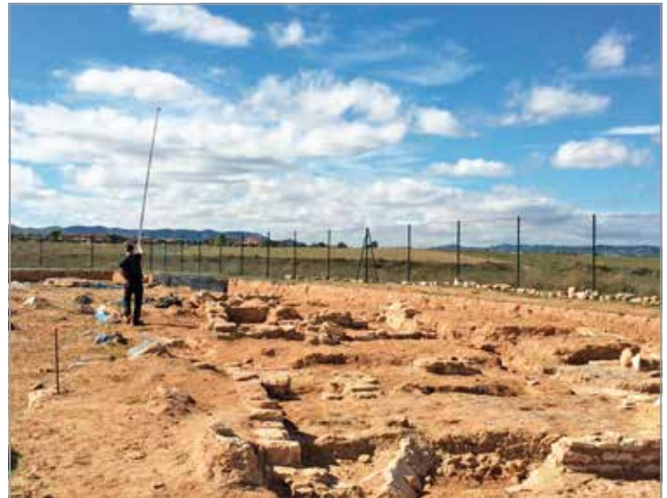
FIG. 91. Toma de datos en el yacimiento arqueológico de Valdeherrera en la campaña de 2014 mediante sistema de pértiga y apoyo con un sensor GNSS de doble frecuencia.
