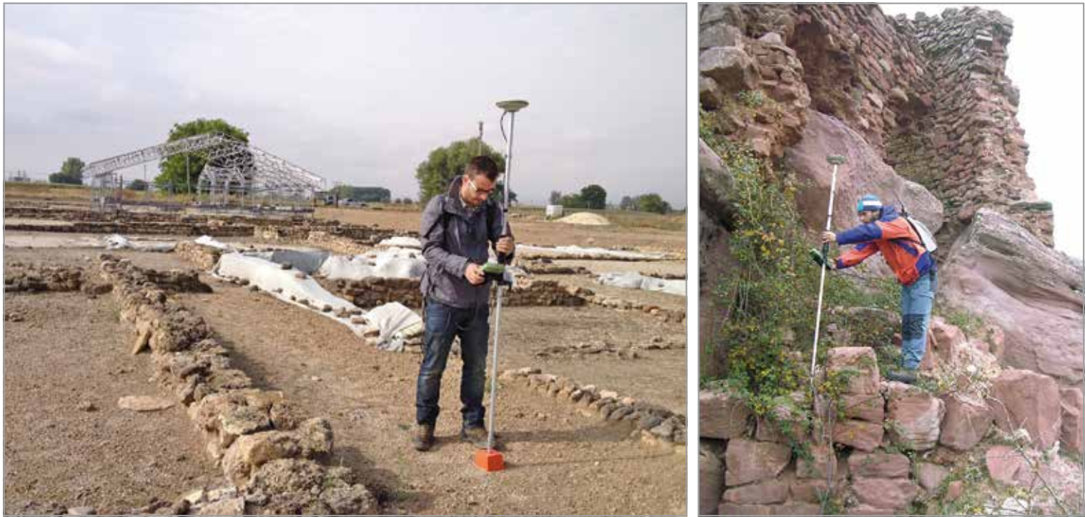
FIG. 48. Sistemas GNSS RTK de doble frecuencia: con radio enlace a estación fija topografiando el Castillo de Losares (Pozondón, Teruel) (dcha.) y el yacimiento de La Caridad (Caminreal, Teruel) colocando puntos de apoyo con conexión a la red de geodesia activa del Gobierno de Aragón ARAGEA para vuelo fotogramétrico (izda.).
