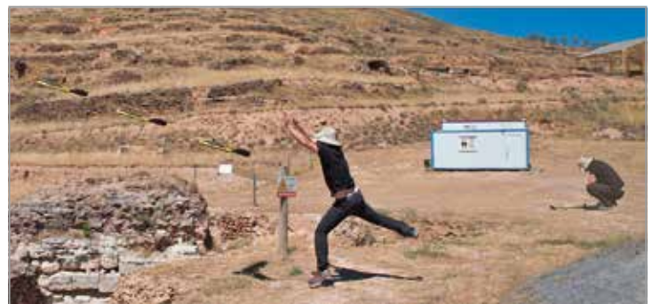
FIG. 33. Secuencia de lanzamiento (montaje sobre un time-lapse ) de un dron de ala fija (eBee) con sensor GNSS RTK (imagen inferior) en el registro fotogramétrico completo del yacimiento de Bilbilis .
