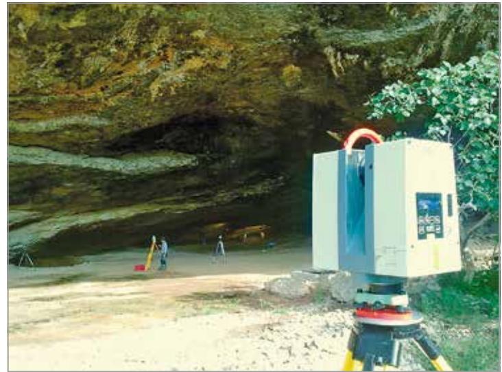
FIG. 172. Estacionamiento de un láser escáner 3D de diferencia de fase utilizado para la documentación del interior de la cavidad junto con una estación total y dianas al fondo.
