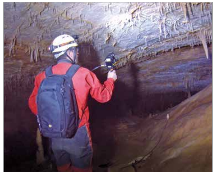
FIG. 54. Adquisición de datos con el sistema mobile laser scanning GeoSlam para documentación tridimensional en entonos subterráneos.
