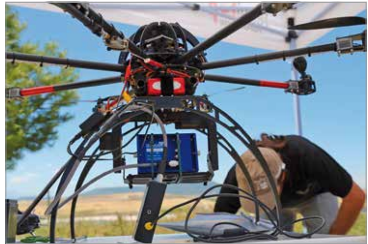
FIG. 43. Adaptación e integración del sistema multirrotor desarrollado con un sensor multiespectral Tetracam Mini-MCA 6 en el yacimiento arqueológico de El Morredón (Fréscano, Zaragoza).
